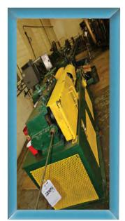
Wir verfügen über 4 Begradigungs- und Schneidmaschinen, die Kohlenstoffdraht von 0,062" bis 0,5" Zoll und 0,062" bis 0,375 Zoll Edelstahldraht begradigen und schneiden können.
