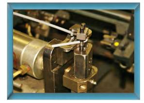
Die CNC Drahtbiegemaschine biegt und formt Drah von 0,093 bis 0,312 Zoll automatisch.
