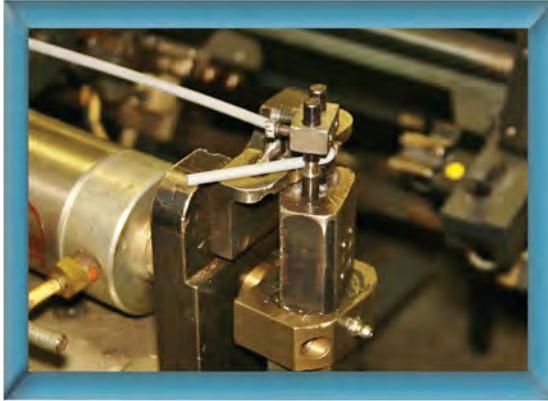
La dobladora de alambres CNC dobla y forma de manera automática alambres de 0,093" a 0,312".
