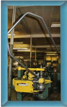
Tenemos 2 máquinas dobladoras de tubos CNC que pueden elaborar tuberías con tubos de 1/4" a 2". Tenemos 3 dobladoras manuales de la marca Pines que doblan tubos de 1/4" y hasta 2 tubos de 1/2". Tenemos 2 dobladoras hechas a medida para trabajos especiales.
