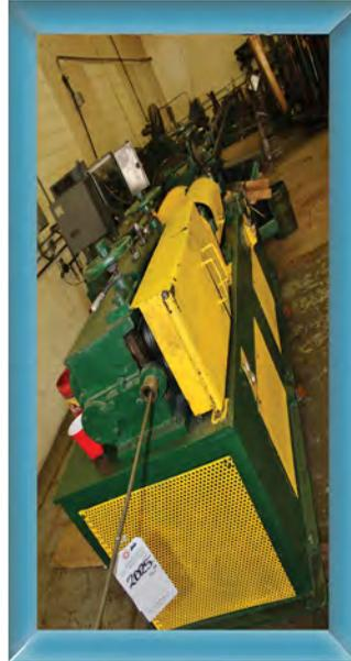
Tenemos 4 máquinas enderezadoras y cortadoras de alambres que enderezan y cortan alambres de carbono de 0,062" a 0,5" y alambres de acero inoxidable de 0,062" a 0,375".
